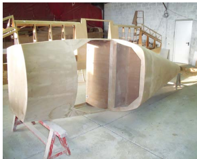
Le fuselage du Jodel D-21 dans les ateliers de l'ASERCAA
